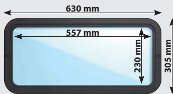
Rundade hörn ( r=60 mm), utmärkt isolerande värde
